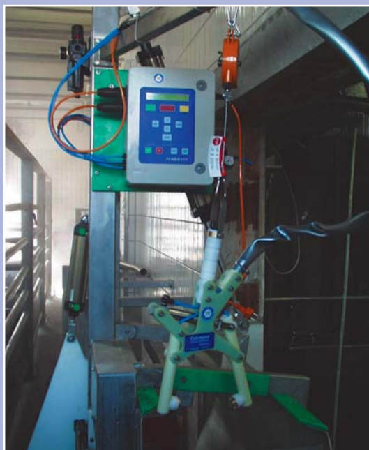
Betäubungsgerät FBT 2000 A, in Kombination mit unterschiedlichen Betäubungsfallen und pneumatischer Zange FBTZ
