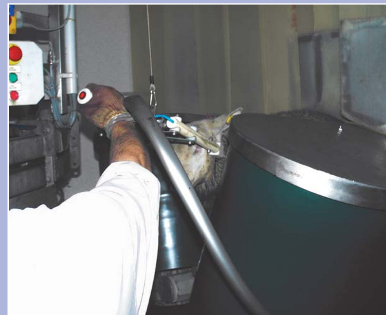
Betäubungsgerät FBT 2000 A, mit pneumatischer Zange FBTZ in Kombination mit Restrainer zur Schafbetäubung
